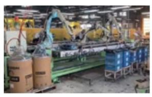
特にサインタワーなどの制御も完成し、作業者がリアルタイムで溶接ロボットのトラブルによる停止に気付ける仕組みが完成。停止状況の見える化に繋がり、原因究明や予防保全につなげていききっかけとなりました。
